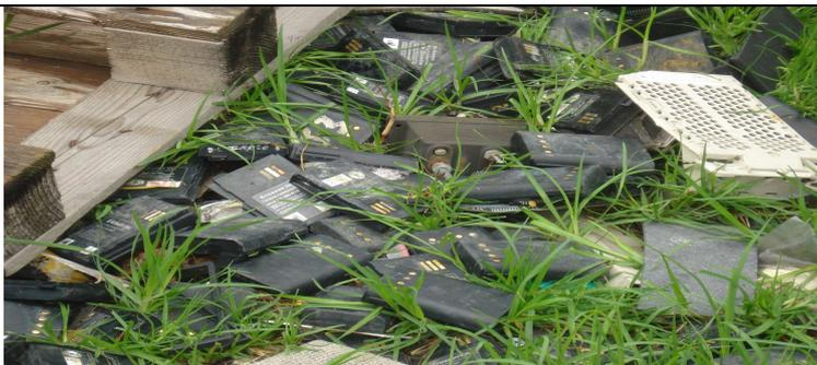
Se observa baterías de radioteléfonos, en contacto con el piso a cielo abierto. Este elemento contiene entre otros metales pesados, como
